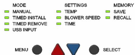
8. Premere il pulsante Scelta e scegliere la velocità della soffiante (1-9) utilizzando i tasti di Scorrimento (▲▼). Premere il pulsante Scelta una volta finito.
